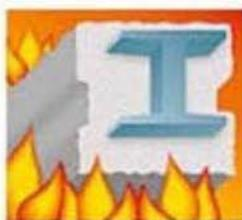
Cuando el sistema es expuesto al fuego, alrededor de 250°C, el sistema empieza a reaccionar, formando una espuma de carbón la cual puede ser de 10 a 100 veces el espesor de película seca del Recubrimiento original, obteniéndose un aislamiento del sustrato de los daños y efectos del fuego.
