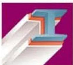
El siguiente paso es la aplicación del Recubrimiento Intumescente de color blanco sobre el primario. El espesor que se debe aplicar dependerá de la masividad del elemento a proteger y según el factor de resistencia al fuego requerido.
